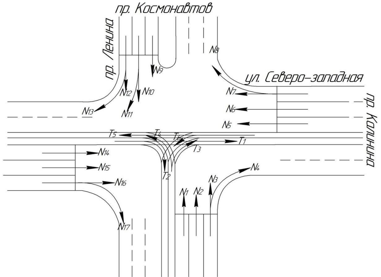
Рисунок 1 – Схема перекрестка с указанием потоков
