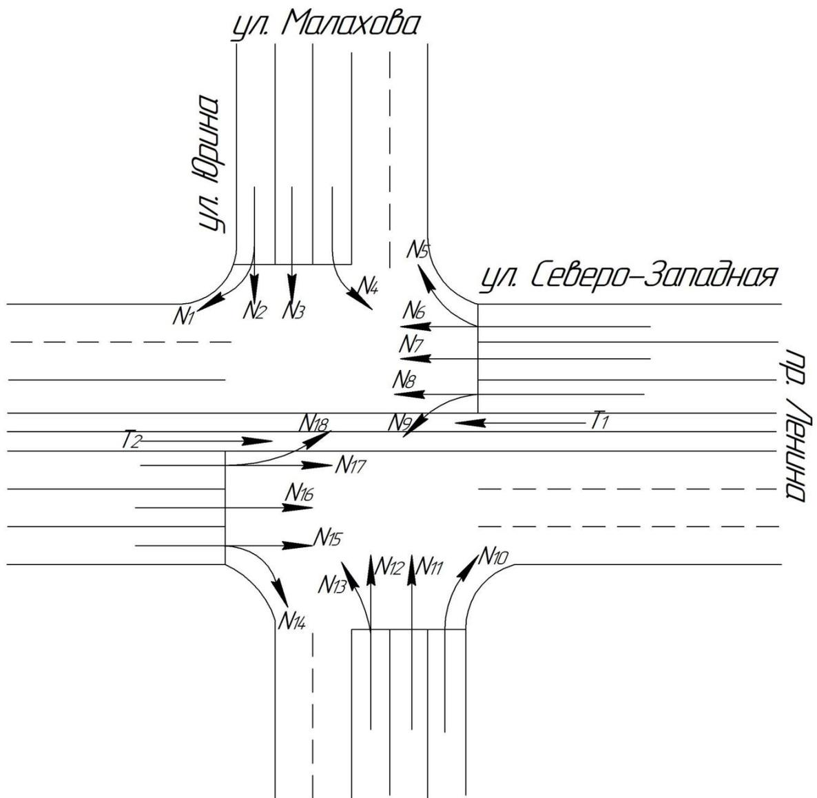
Рисунок 1 – Схема перекрестка с указанием потоков
