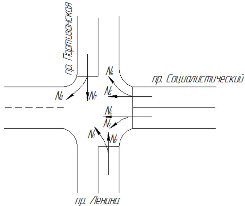
Рисунок 1 – Схема перекрестка с указанием потоков
