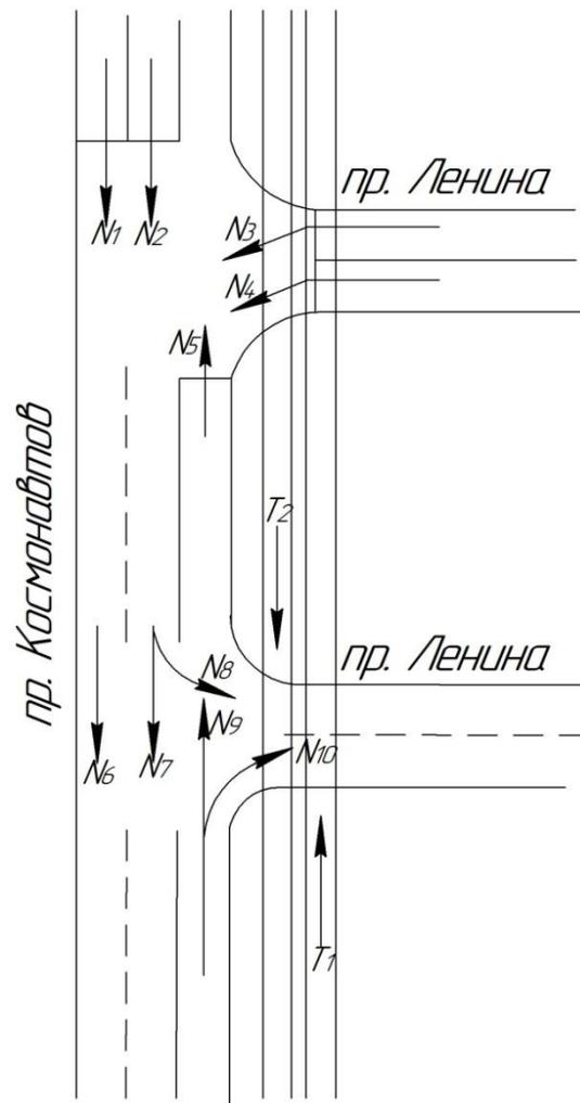
Рисунок 1 – Схема перекрестка с указанием потоков
