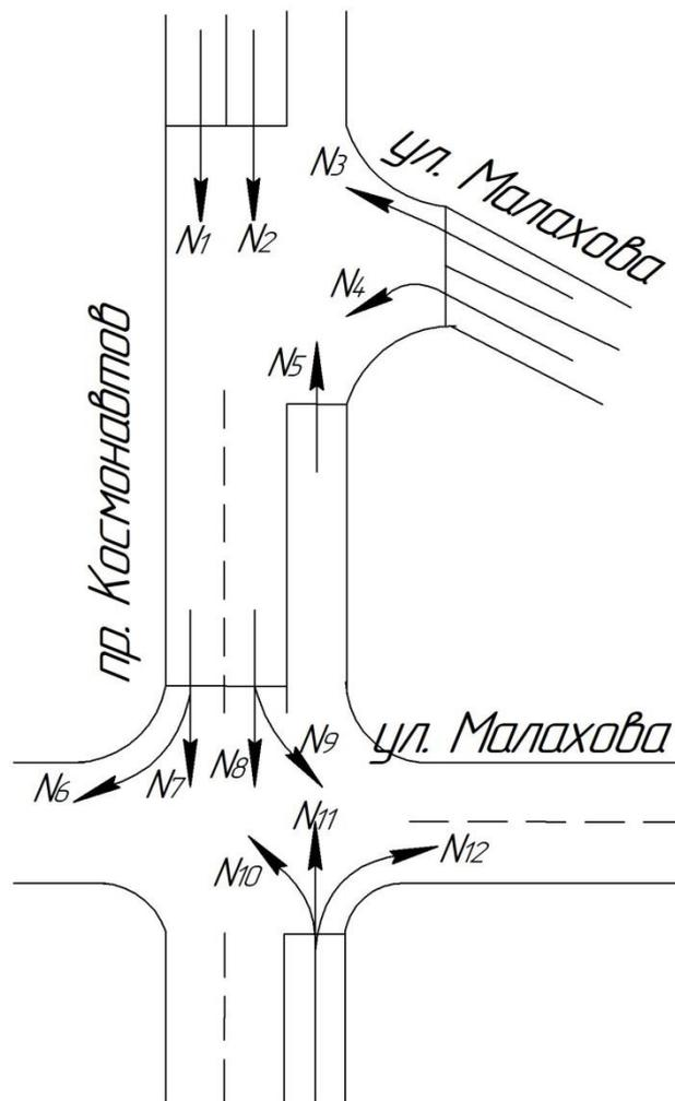
Рисунок 1 – Схема перекрестка с указанием потоков
