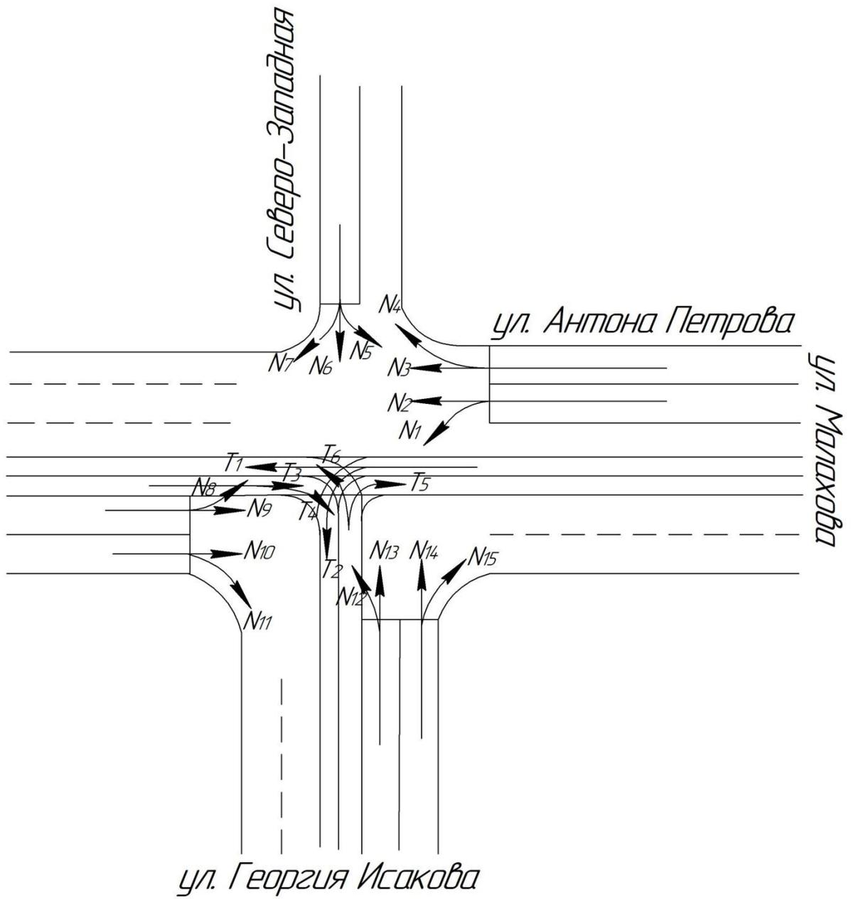
Рисунок 1 – Схема перекрестка с указанием потоков
