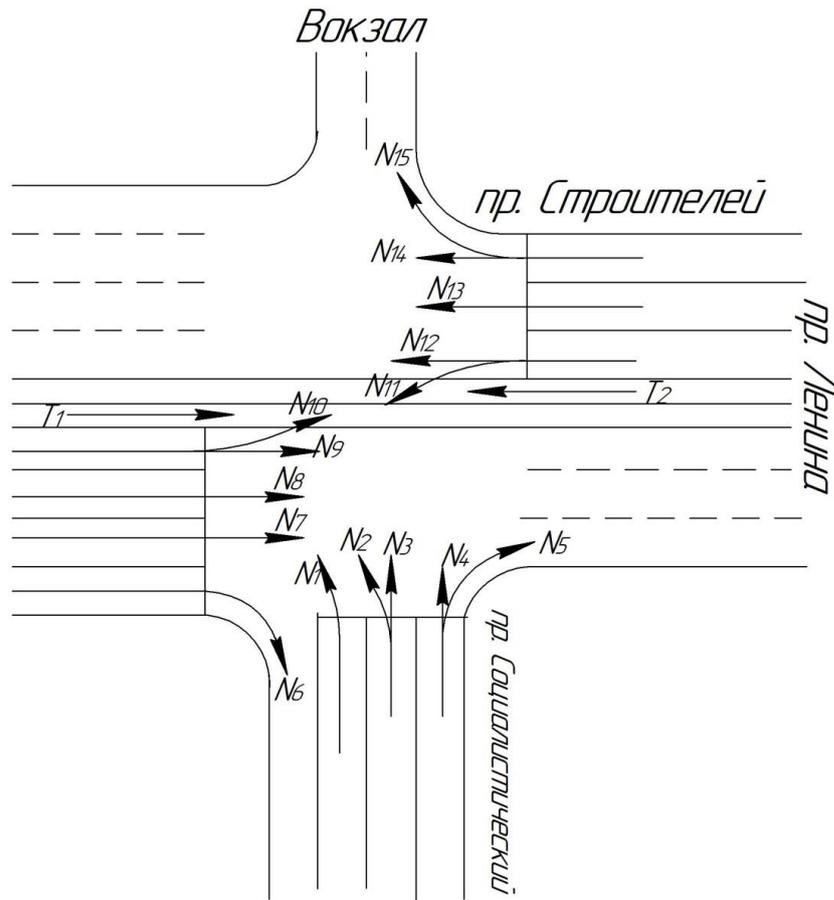
Рисунок 1 – Схема перекрестка с указанием потоков
