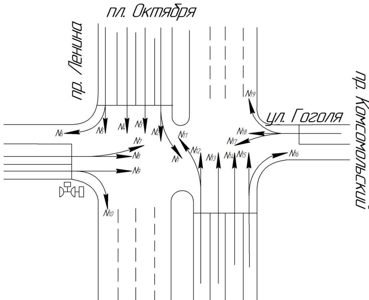
Рисунок 1 – Схема перекрестка с указанием потоков
